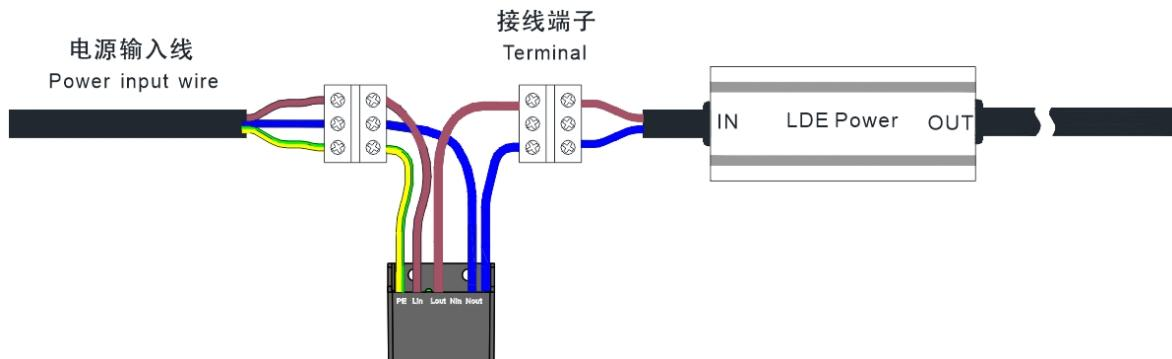
注: 1、SPD 的 PE 线应与整机的接地端子连接。
