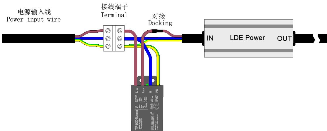
注: 1、SPD 的 PE 线应与整机的接地端子连接。
